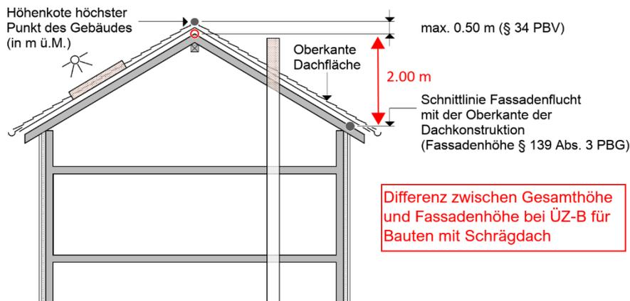
○ Höchste Punkte der Dachkonstruktion (Gesamthöhe § 139 Abs. 1 PBG)
