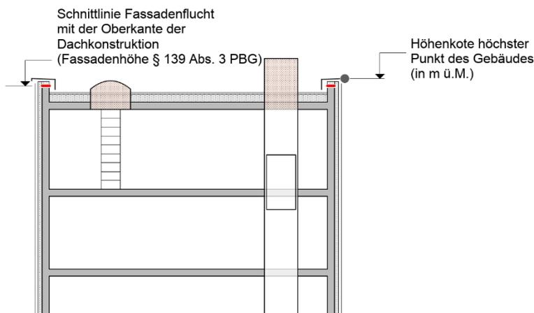
— Höchste Punkte der Dachkonstruktion (Gesamthöhe § 139 Abs. 1 PBG)
